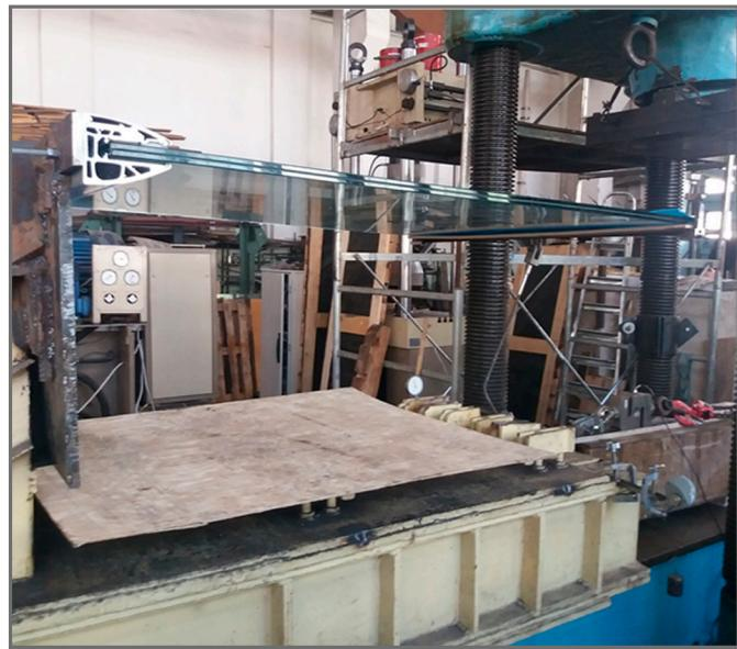
Система стеклянных козырьков сертифицирована, прошла испытания на несущей способность козырька при приложении распределенной нагрузки. Достигнутая предельная распределенная нагрузка на консоль составила **589,6 кгс/м<sup>2</sup>**
